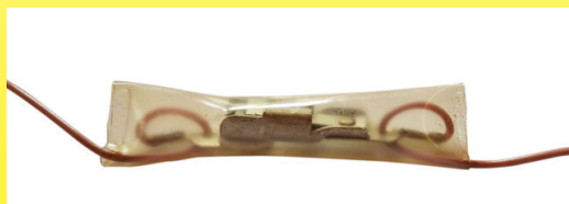
Limitador de temperatura de manta térmica de rotura lenta Calor, calibrado a 80 °C (circa 1960). Nótese la funda impermeable de PVC soldada en los cables y el bucle hecho por los conductores eléctricos que pasan por un agujero en cada terminal, esto es para eliminar tensiones de tracción en el cable (Colección Ultimheat)
