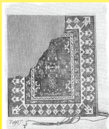
Vista interior de la estera calefactora, arriba a la izquierda - cables cruzados por la corriente, abajo a la derecha – enchufe de alimentación (1904, La Nature, colección Ultimheat)
