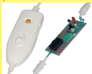
2019 Unidad de Control Continuo de Potencia Electrónica para Manta (Colección Ultimheat)
