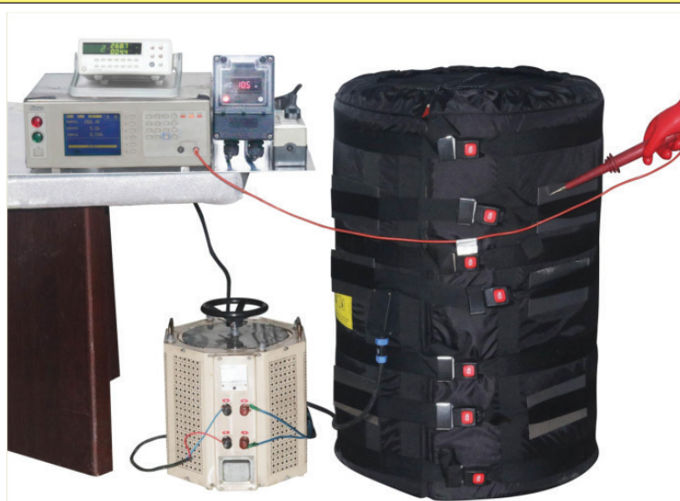
Equipo de medición para la corriente total de fuga en caliente
